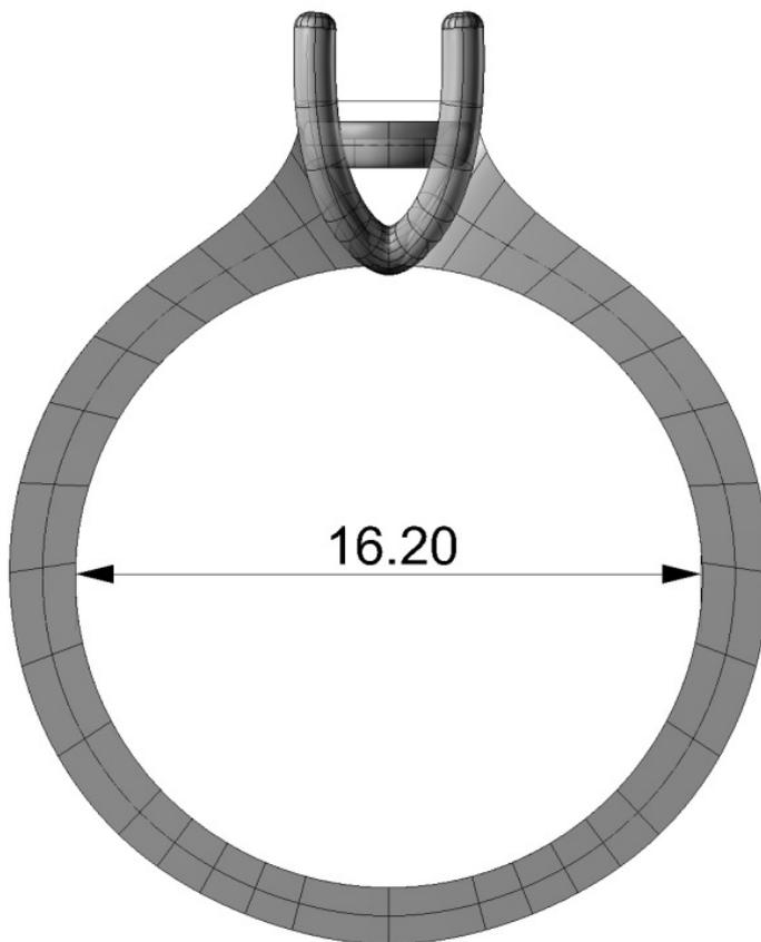
Esempio di misura del diametro interno.
